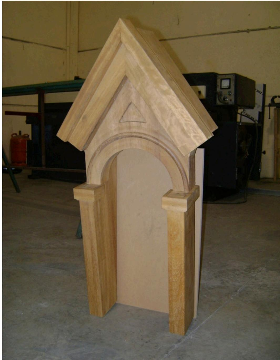
*Ventana de madera del chapitel preparada para ser cubierta con las planchas de plomo en el taller*
