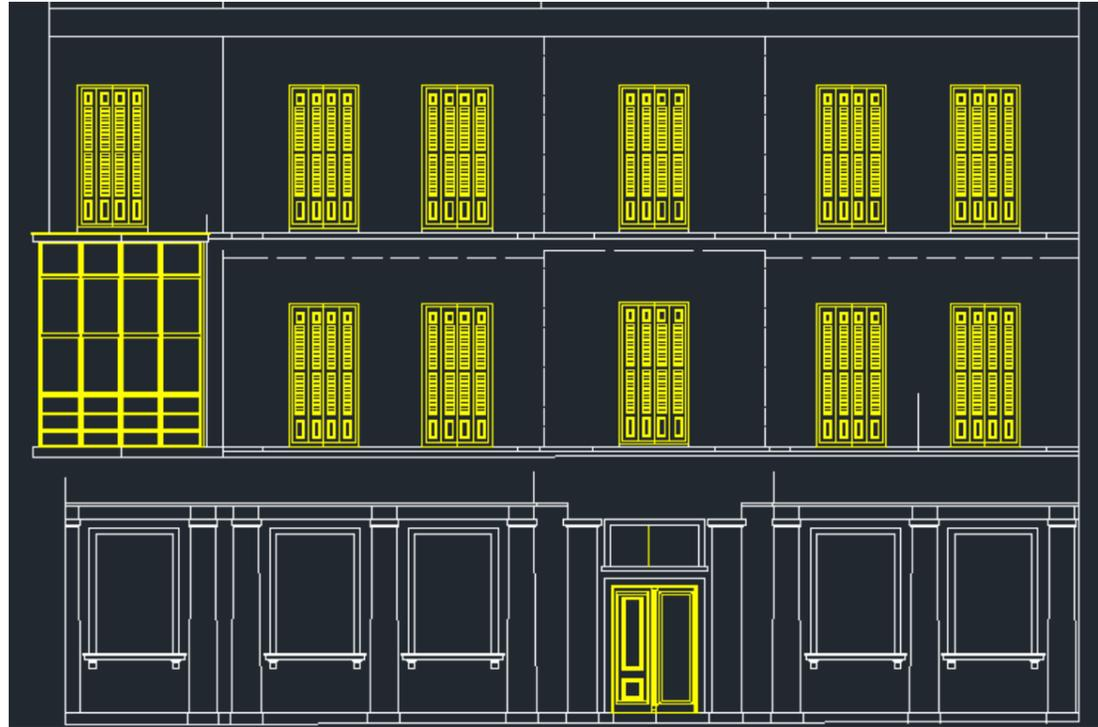
4. Una vez tenemos las ventanas y portones de madera con la capa de carpinterías, cambiamos de capa y escogemos las de forja de hierro para realizar las barandillas o rejas de ventana.
